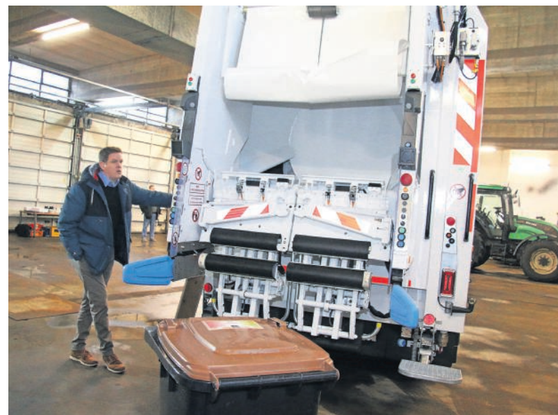
Mit dem modernen Drehrommelfahrzeug von der Firma Faun Umwelttechnik soll künftig der Biomüll aus den „Brauen Tonnen“ in der Stadt eingesammelt werden.
