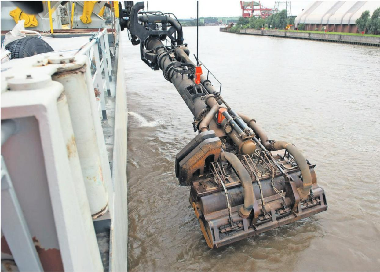
Der Saugkopf des Bagger Schiffes „Bartolomeu Dias“ senkt sich in Hamburg in die Elbe. Das Spezialschiff baggert Schlick aus der Elbe in seinen Laderaum und verklappt diesen anschließend in der Nordsee. Foto: Reinhardt / dpa
